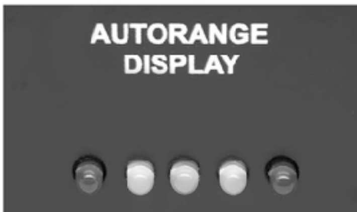
Figure 9 – Vue d'affichage LED - Autorange (panneau avant)
