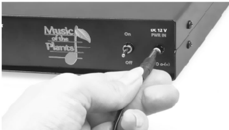
Figure 4 – Vue du transformateur AC-DC et de sa connexion à l'appareil
